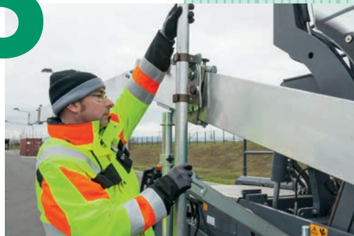
Montar el alojamiento de los sensores
