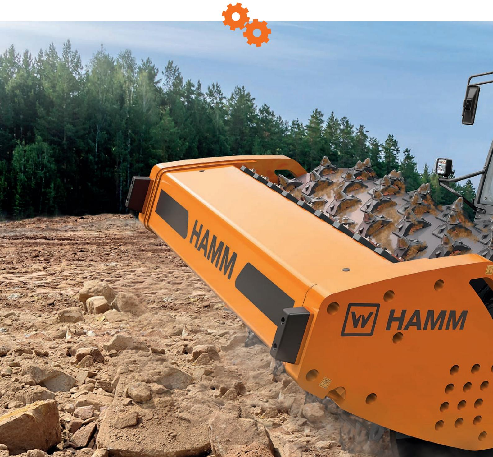
Concassage et compactage de roches en une seule passe - c'est dans ce but que HAMM a développé le compacteur 3625 HT VC avec rouleau de brise-roche. L'élément clé de la machine de 25 t est un rouleau VC de 2,22 m de large (VC, de l'anglais vibration crusher, concasseur par vibration) avec 150 bits. Ils triturent le matériau de roche dure avec des charges extrêmement élevées alors que ce matériau est compacté par le rouleau vibrateur.
