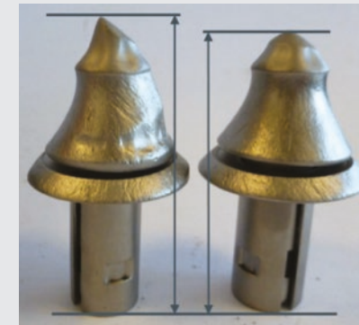
Exemplo: à esquerda, um bit com problema de rotação; à direita, um bit com rotação perfeita
