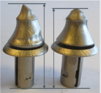
A la izquierda, una pica con problema de rotación; a la derecha, una pica con rotación perfecta
