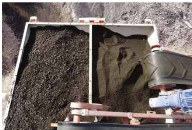
Separação granulométrica em RAP grosso e RAP fino
