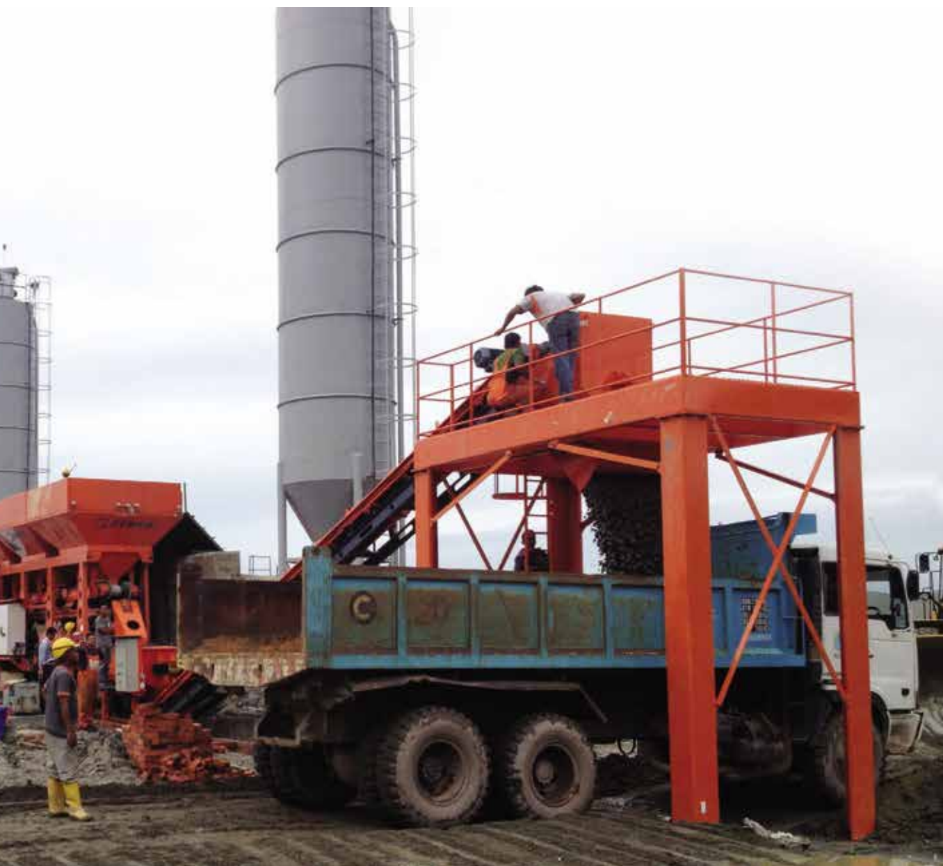
Separação granulométrica em RAP grosso e RAP fino
