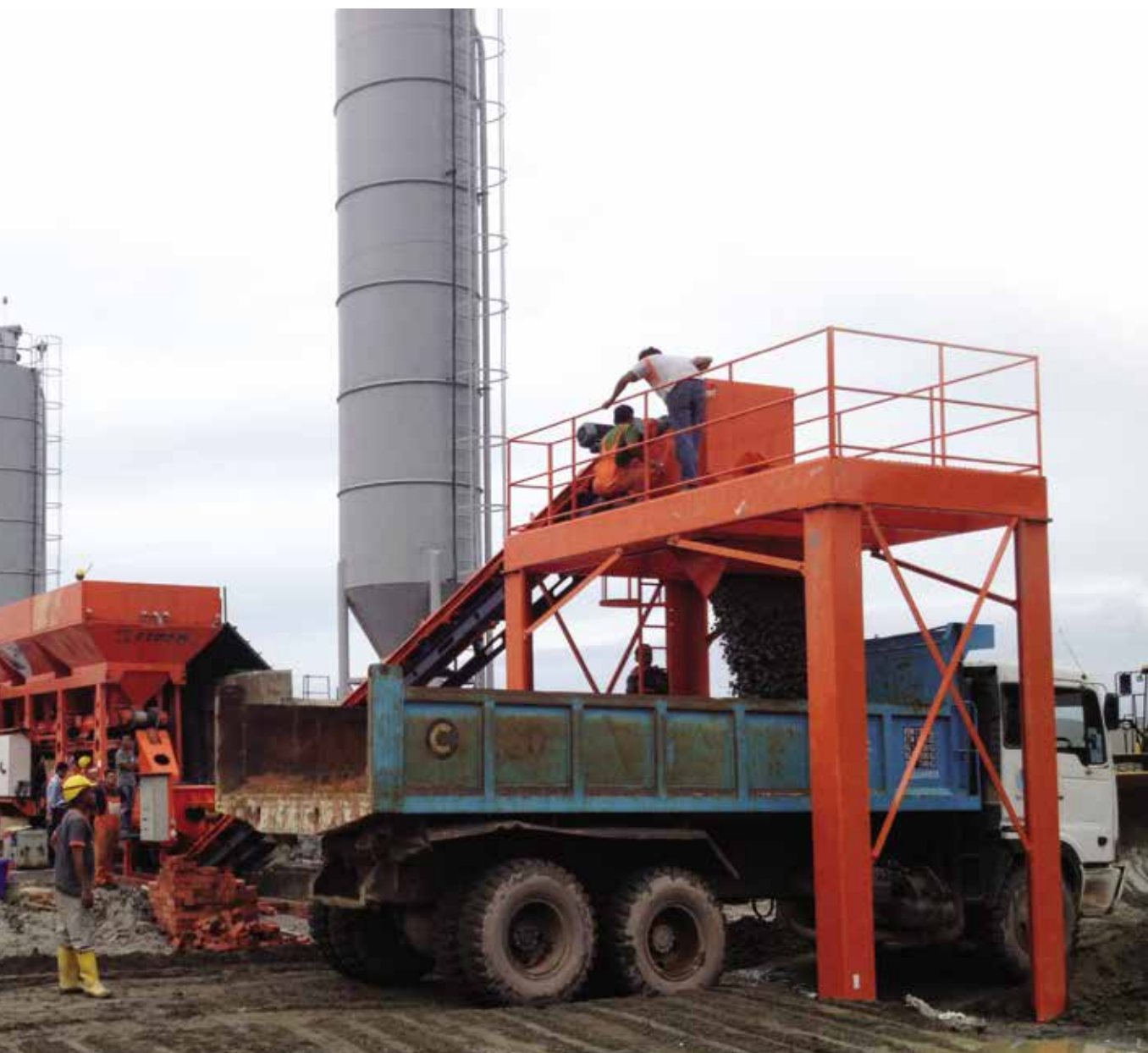
Separación granulométrica en RAP grueso y RAP fino
