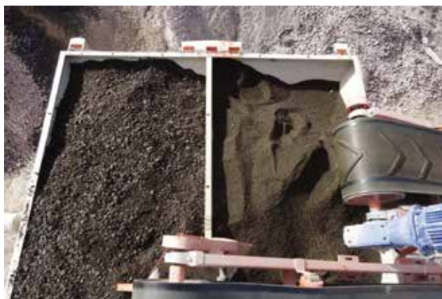
Separación granulométrica en RAP grueso y RAP fino
