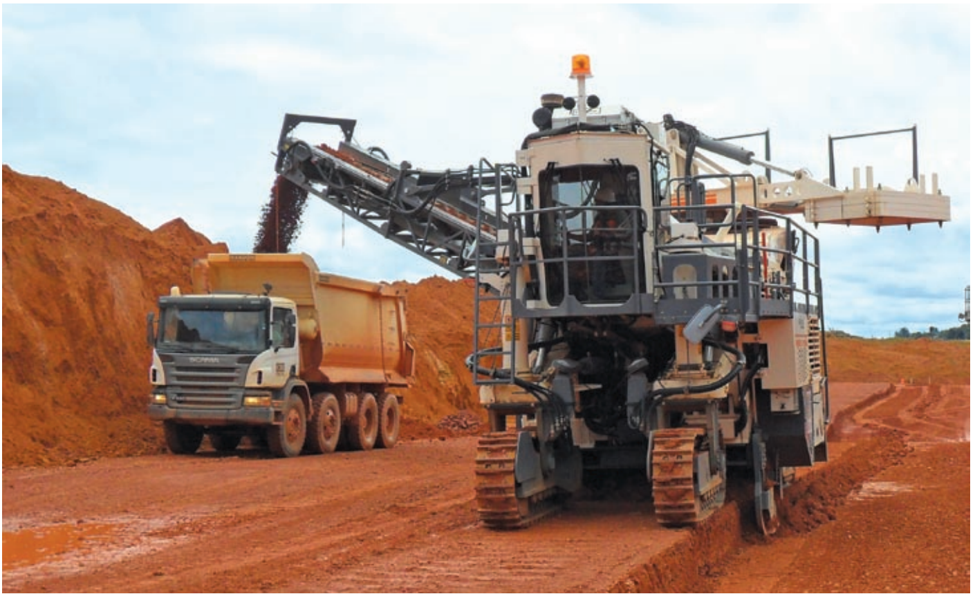
La mineradora tiene correa transportadora para conducir el mineral hasta el camión
