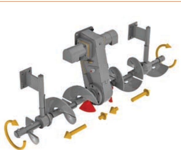
Flujo del material de acuerdo al movimiento del eje helicoidal
