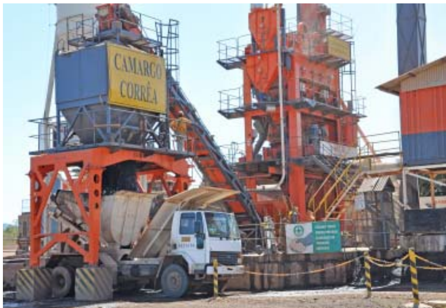
UAB 18 E Advanced possibilita a produção de qualquer tipo de asfalto
