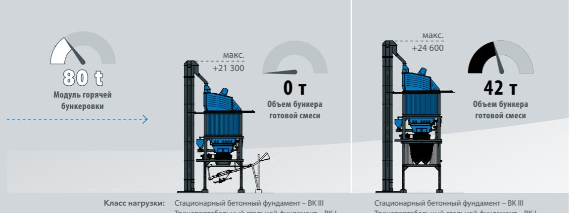
Класс нагрузки: Стационарный бетонный фундамент – ВК III
