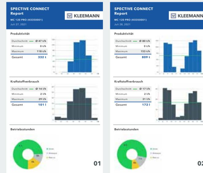
**01** 27.07.2021: Maschine wurde erst ab Mittags betrieben – hohe Diskrepanz zwischen max. Leistung und Durchschnittsleistung – ab 11 Uhr wurde bereits Kraftstoff verbraucht
