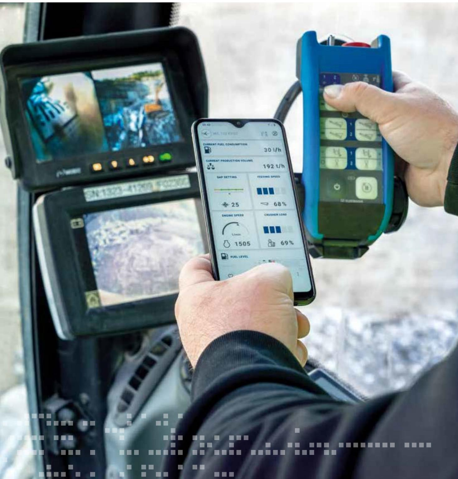
Die kleine Funkfernsteuerung ist dank ihrer kompakten Größe für eine Mitnahme in einem Beschickungsgerät geeignet. Dort werden in der Regel deutlich weniger Funktionen benötigt, wie beim Einrichten der Maschine.
