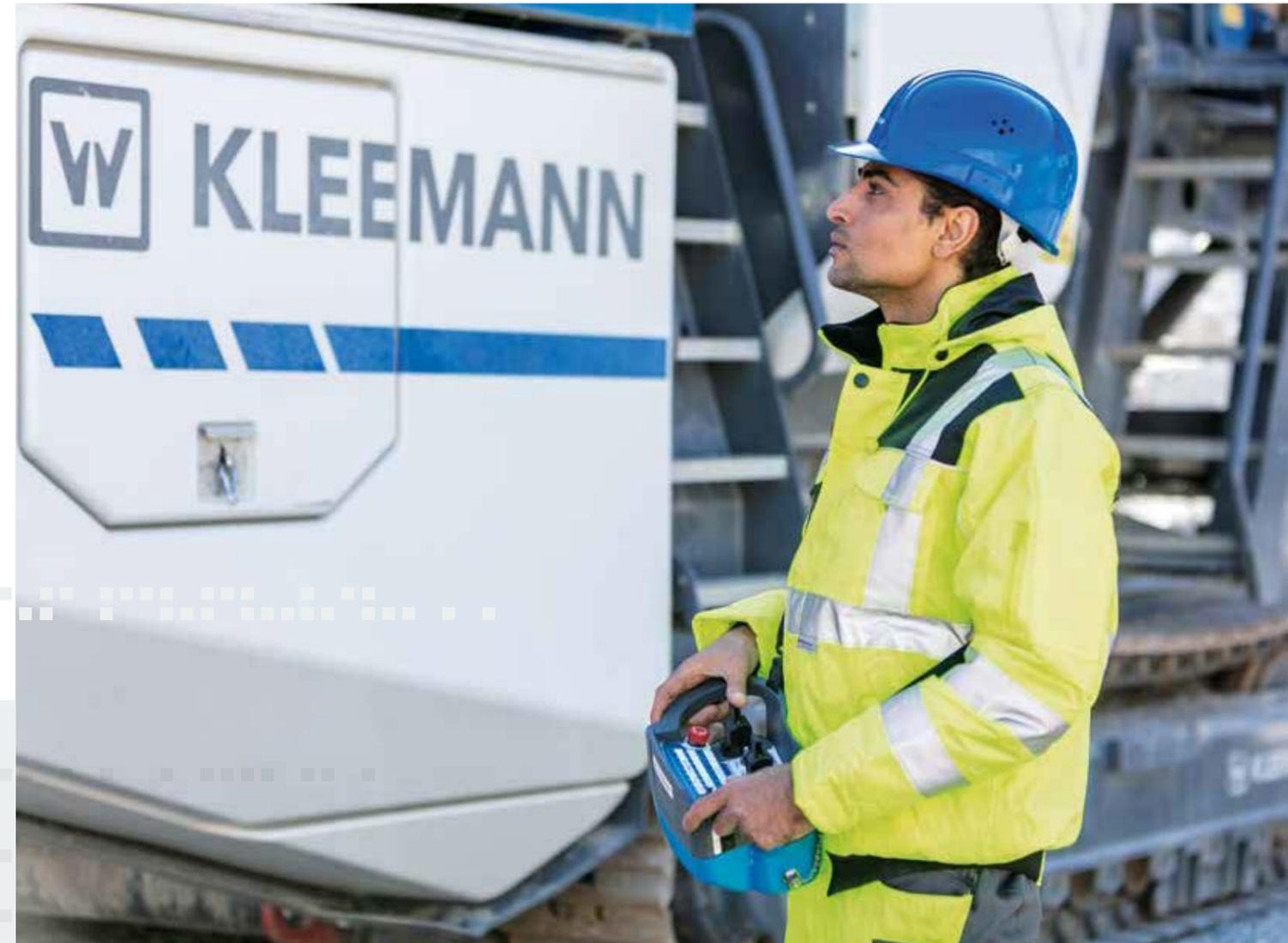
Mit der großen, serienmäßigen Funkfernsteuerung lassen sich alle Funktionen der Anlage inklusive des gesamten Rüst- und Fahrvorgangs aus sicherer Entfernung steuern. Dabei kann sich der Bediener völlig frei bewegen und alles optimal einsehen. Die Anordnung der Bedienfunktionen bildet die logische Arbeitsreihenfolge ab.
