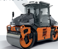
Geteilte Oszillationsbandagen sind verfügbar in den Modellen der Serie DV+. Die entsprechenden Modelle sind am Kürzel "VS-OS" in der Bezeichnung zu erkennen.
