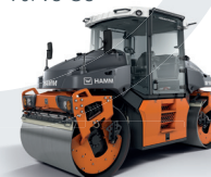
Geteilte Oszillationsbandagen sind verfügbar in den Modellen der Serie DV+. Die entsprechenden Modelle sind am Kürzel "VS-OS" in der Bezeichnung zu erkennen.
