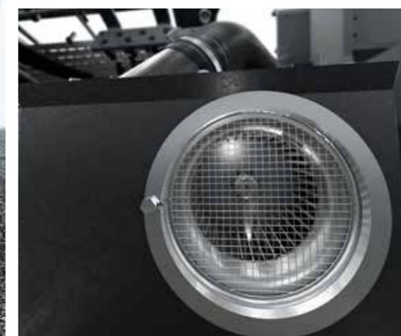
**PAS DE BRUIT SUPPLÉMENTAIRE :** le ventilateur a pu être installé à l'intérieur de la machine.\*
