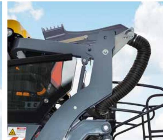
**PAS DE DÉMONTAGE :** le conduit d'évacuation se replie avec le toit pour le transport.\*
