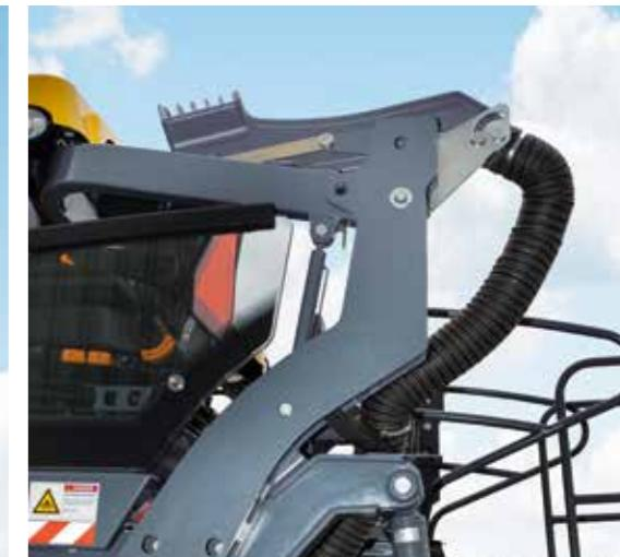
**SIN DESMONTAJE:** el tubo de escape se pliega junto con el techo para el transporte.\*
