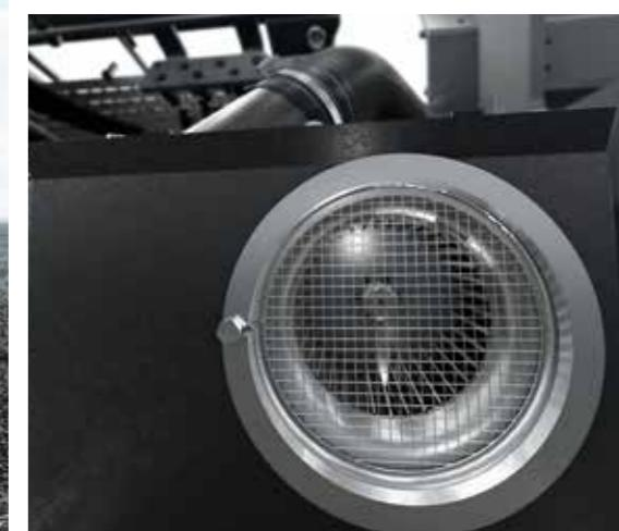
**SIN CONTAMINACIÓN ACÚSTICA ADICIONAL:** el ventilador se ha podido colocar en el interior de la máquina.\*
