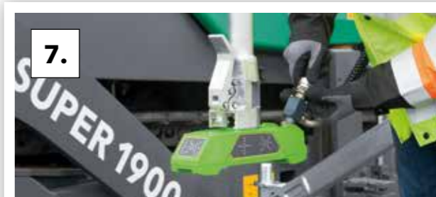
7. Poser le câble et raccorder les palpeurs.
