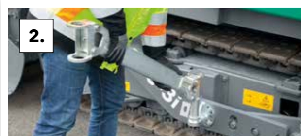
2. Installer les bras pivotants.
