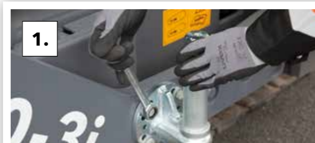
1. Monter les deux supports sur le bras de table.
