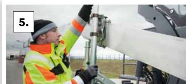
5. Monter les supports de palpeur.
