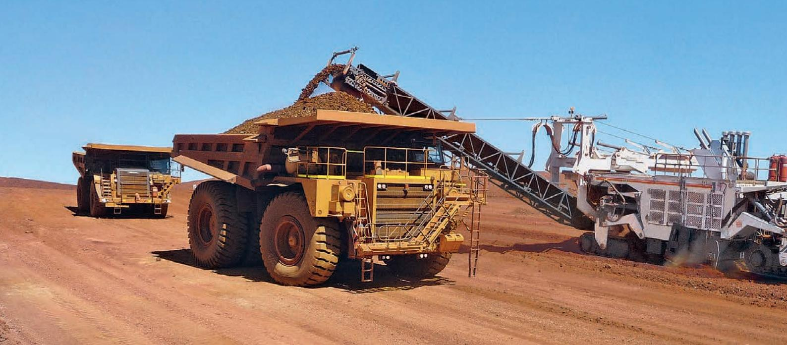
Una delle principali caratteristiche dei surface miner WIRTGEN è la loro capacità di caricare il materiale tagliato direttamente su camion - come il modello 4200 SM qui raffigurato. Il nastro convogliatore è brandeggiabile di 90 gradi verso entrambi i lati e regolabile in altezza.
