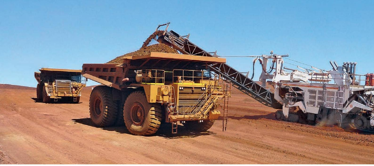
Eins der wichtigsten Merkmale der WIRTGEN Surface Miner ist deren Fähigkeit, das geschnittene Material direkt auf Lkw zu verladen - wie hier beim 4200 SM. Das Band ist nach beiden Seiten um je 90 Grad schwenkbar und in der Höhe einstellbar.
