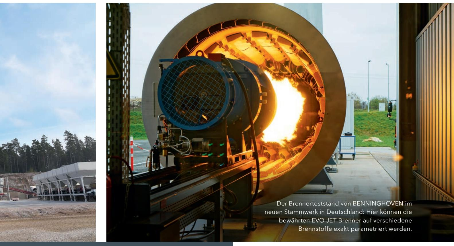
Der Brennerteststand von BENNINGHOVEN im neuen Stammwerk in Deutschland: Hier können die bewährten EVO JET Brenner auf verschiedene Brennstoffe exakt parametriert werden.
