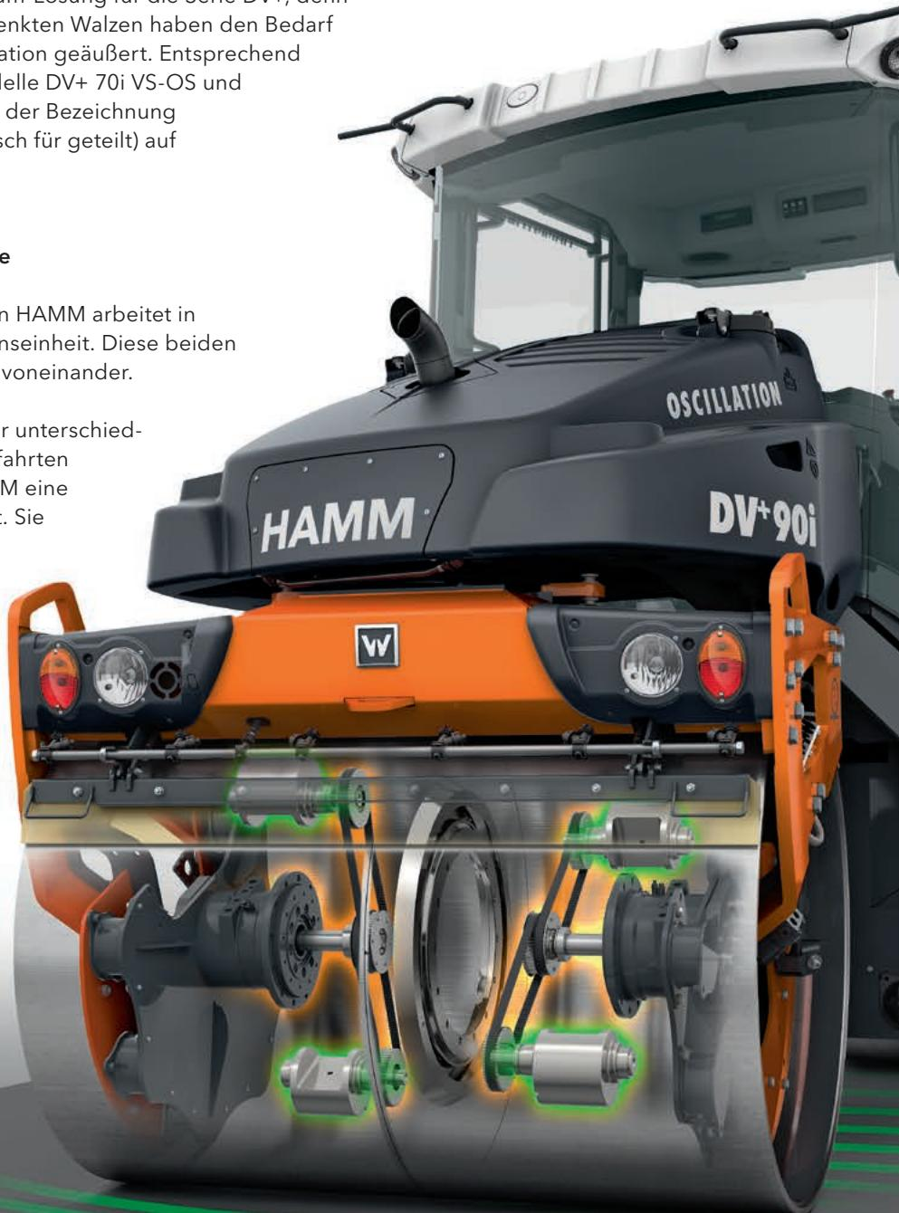
Die Walzen der Serie DV+ sind serienmäßig vorne und hinten mit einer geteilten Bandage ausgerüstet. Bei den „OS“-Modellen ist die hintere Bandage als Oszillationsbandage ausgeführt.
