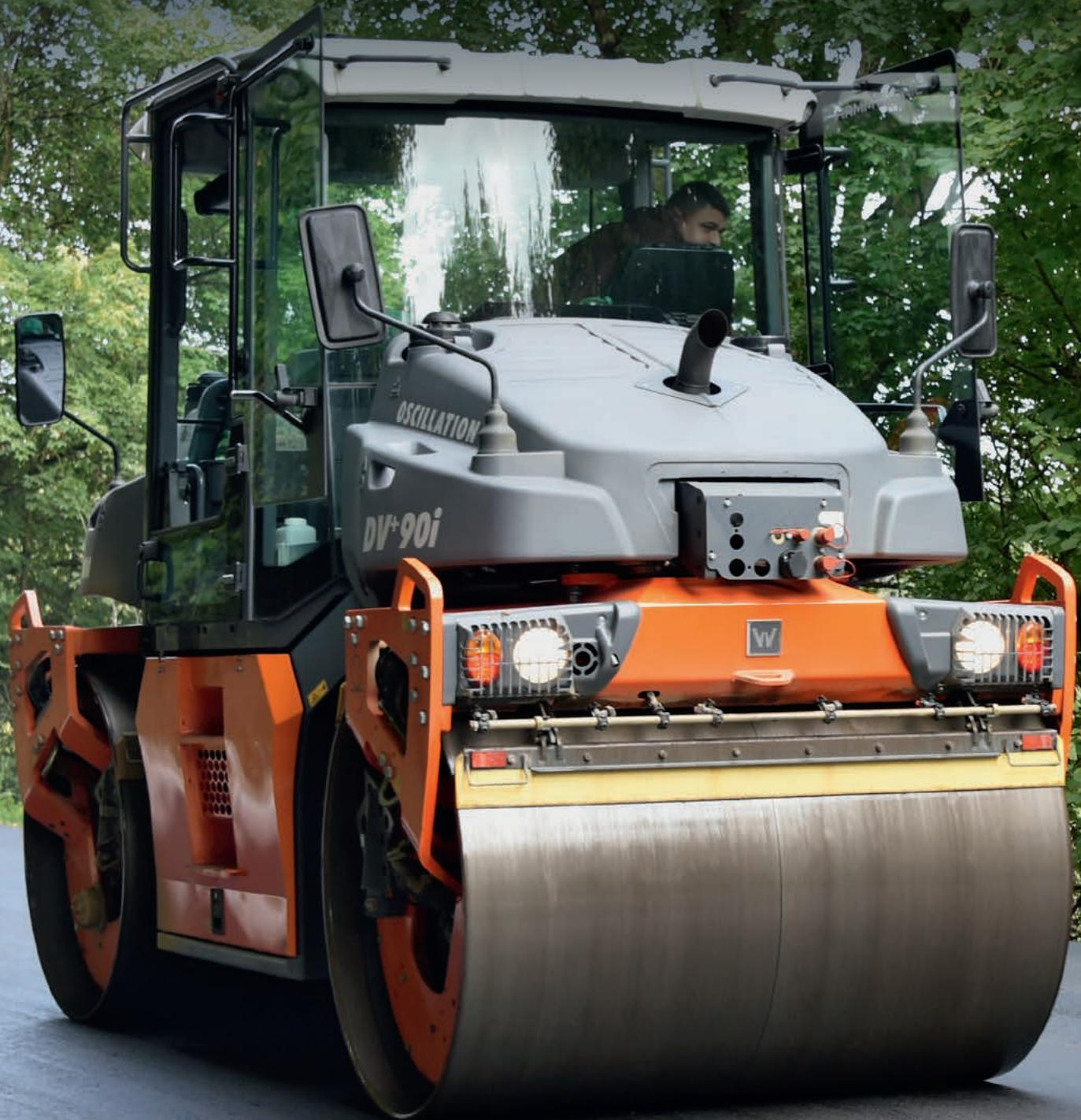
Mit der geteilten Oszillationsbandage von HAMM können Baufirmen selbst bei anspruchsvollen Aufgaben in kurzer Zeit hervorragende Verdichtungsergebnisse erzielen – insbesondere bei der Verdichtung in Kurven.
