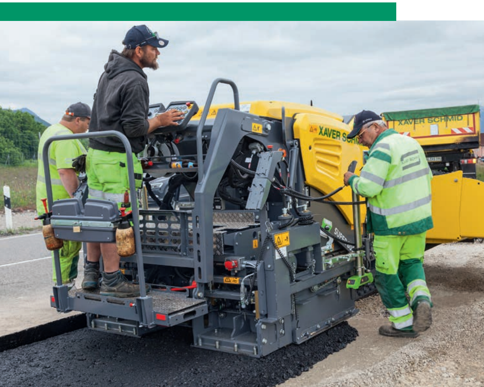
Central de mando moderna: la consola de mando del conductor según el concepto ErgoBasic, con el que se comandan todas las exten- dedoras VÖGELE de la Classic Line, como p. ej. la SUPER 800i
