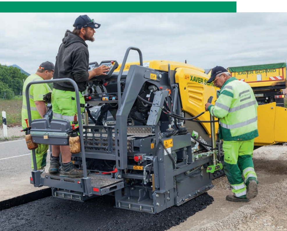
Moderne Kommandozone: Die Fahrer-Bedienkonsole des Bedienkonzepts ErgoBasic, mit dem alle VÖGELE Fertiger der Classic Line wie der SUPER 800i gesteuert werden.
