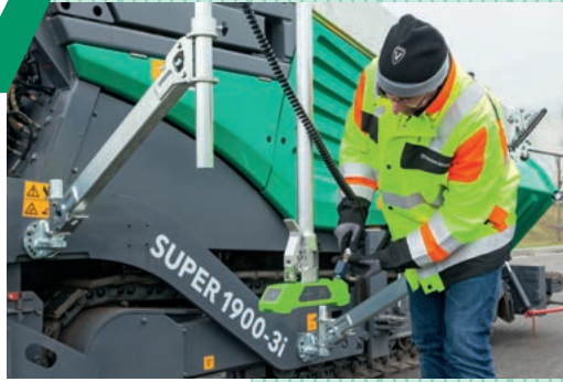
Poser le câble et raccorder les palpeurs
