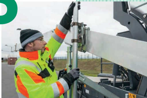
Monter les supports de palpeur
