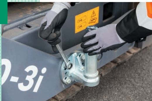
Monter les deux supports sur le bras de table
