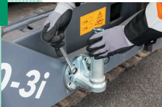
Montar los dos soportes en el larguero de la regla
