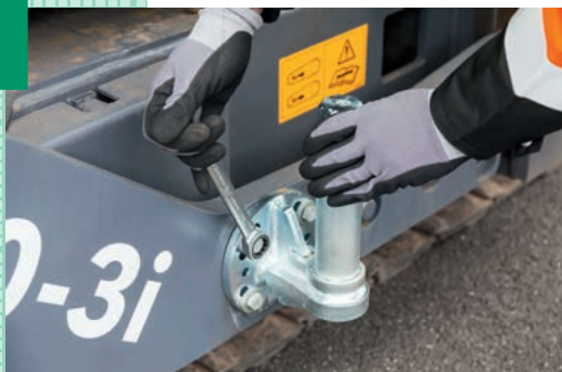
Die beiden Halterungen am Bohlenholm montieren
