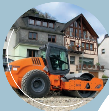
Movimiento de tierras entre una vía de ferrocarril y edificios históricos en Oberwesel, Alemania: para no dañar las casas de paredes entramadas ni el sensible terreno de la vía, aquí únicamente era posible realizar la prestación requerida con un solo rodillo con oscilación.
