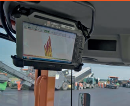
На панель ПК в кабине можно вывести различные карты уплотнения (здесь: количество переездов). При этом навигатор HCQ показывает ход уплотнительных работ всей команды в режиме реального времени.
