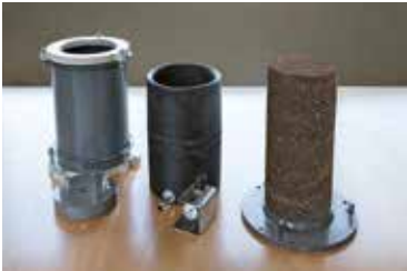
Selon la méthode d'essai envisagée, le WLW 1 permet de réaliser des éprouvettes de différentes hauteurs. Leur qualité est ensuite vérifiée par un test de résistance au cisaillement.
