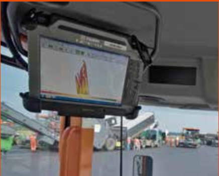
En el PC de panel dispuesto en la cabina se pueden visualizar diferentes mapas de compactación (aquí: número de pasadas). Además, el navegador HCQ visualiza en directo el avance de compactación de todo el equipo. ///
