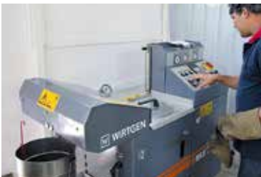
Con ayuda del sistema de laboratorio WLB 10 S se pueden realizar series de medición para averiguar las propiedades del betún espumado.
