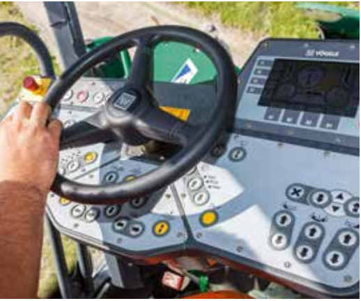
Consola de mando del conductor ErgoPlus 3 de estructura intuitiva: la extendedora sobre ruedas SUPER 1803-3i se puede controlar fácilmente y con precisión mediante un volante.
