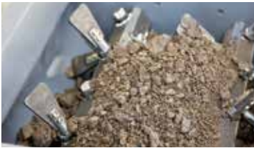
La mezcladora de circulación forzada de dos ejes WLM 30 para lotes de aprox. 30 kg se caracteriza por su gran intensidad de mezcla.
