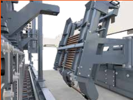
Längsfugenankersetzer: Die automatisch eingesetzten Längsfugenanker verhindern das Auseinanderwandern von Fahrbahnen.
