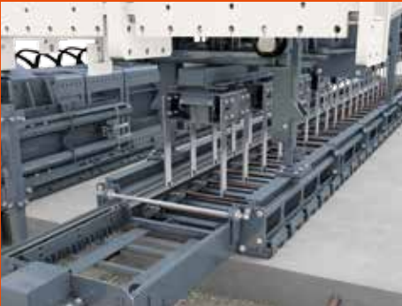
Das im Maschinenrahmen integrierte Dübelsetzgerät (DBI) setzt die Dübel lage- recht ein, um die Höhenlage benachbarter Platten zu sichern.
