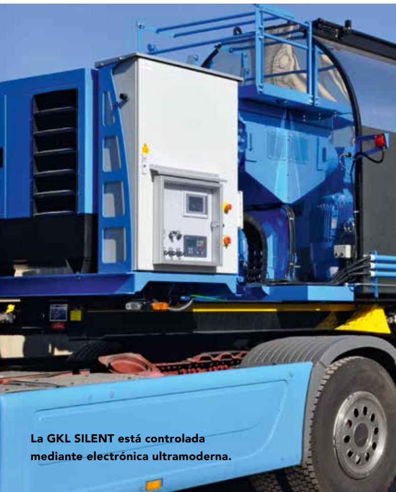
La GKL SILENT es ideal para la preparación homogénea de mástico asfáltico y posibilita realizar un óptimo proceso de mezcla durante el transporte.
