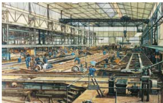
Dibujo de 1916: trabajadores fabricando puntos de transbordo donde se daba la vuelta a locomotoras y otros vehículos del ferrocarril.
