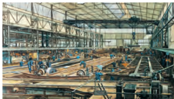
Zeichnung von 1916: Arbeiter fertigten Drehscheiben, mit denen Lokomotiven und andere Schienenfahrzeuge gewendet wurden.
