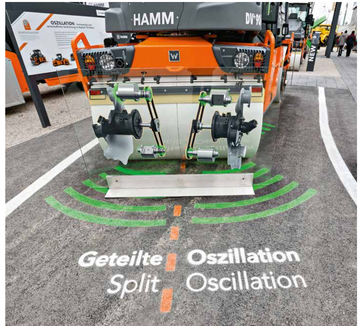
Geteilte Oszillation: Kombiniert die Vorteile der Oszillationstechnologie mit den Vorteilen einer geteilten Bandage.
