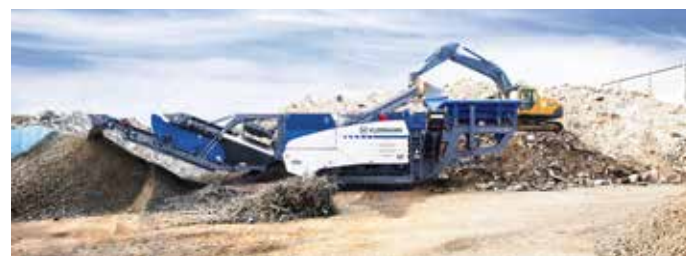
Das Continuous Feed System der MOBIREX MR 130 Z EVO2 verfügt über Sensoren für eine optimale Befüllung der Brechkammer.
