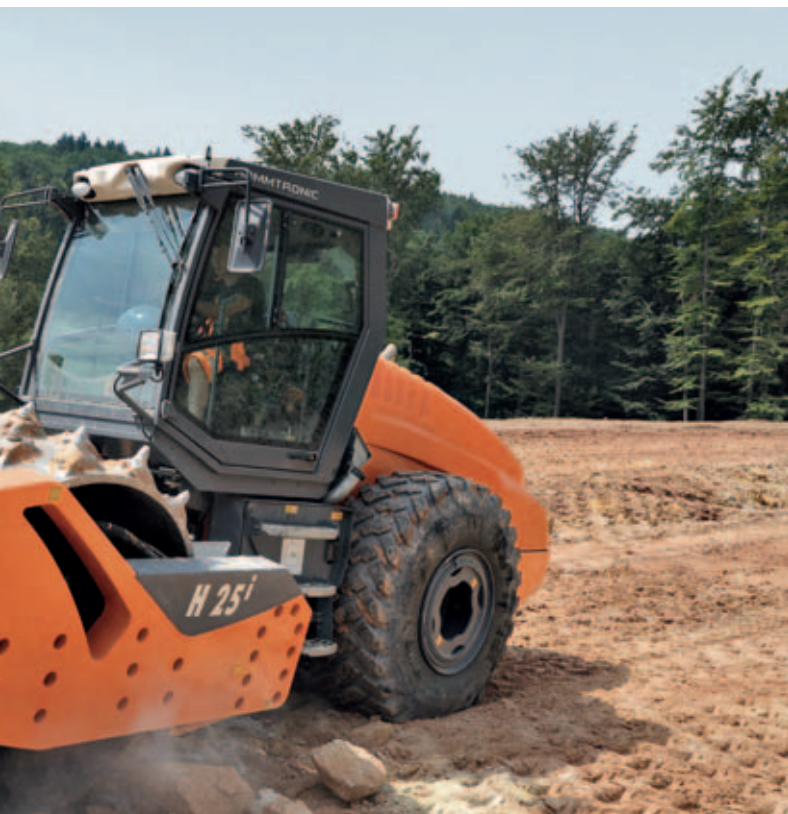
Mit VC-Walzenzügen von Hamm lässt sich Gestein brechen und verdichten (1). Teamwork: Thomas Lehnert (r.), Thomas Allgaier und Benjamin Grüber im Wirtgen Stammwerk (2).
