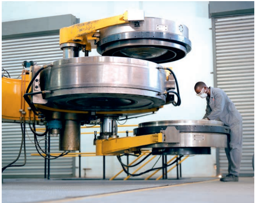
> Pressa per la produzione di punte in PCD in procedure a elevata temperatura ed elevata pressione
