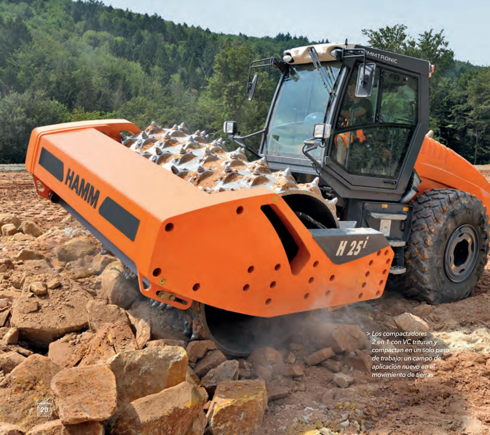
> Los compactadores 2 en 1 con VC trituran y compactan en un solo paso de trabajo: un campo de aplicación nuevo en el movimiento de tierras.
