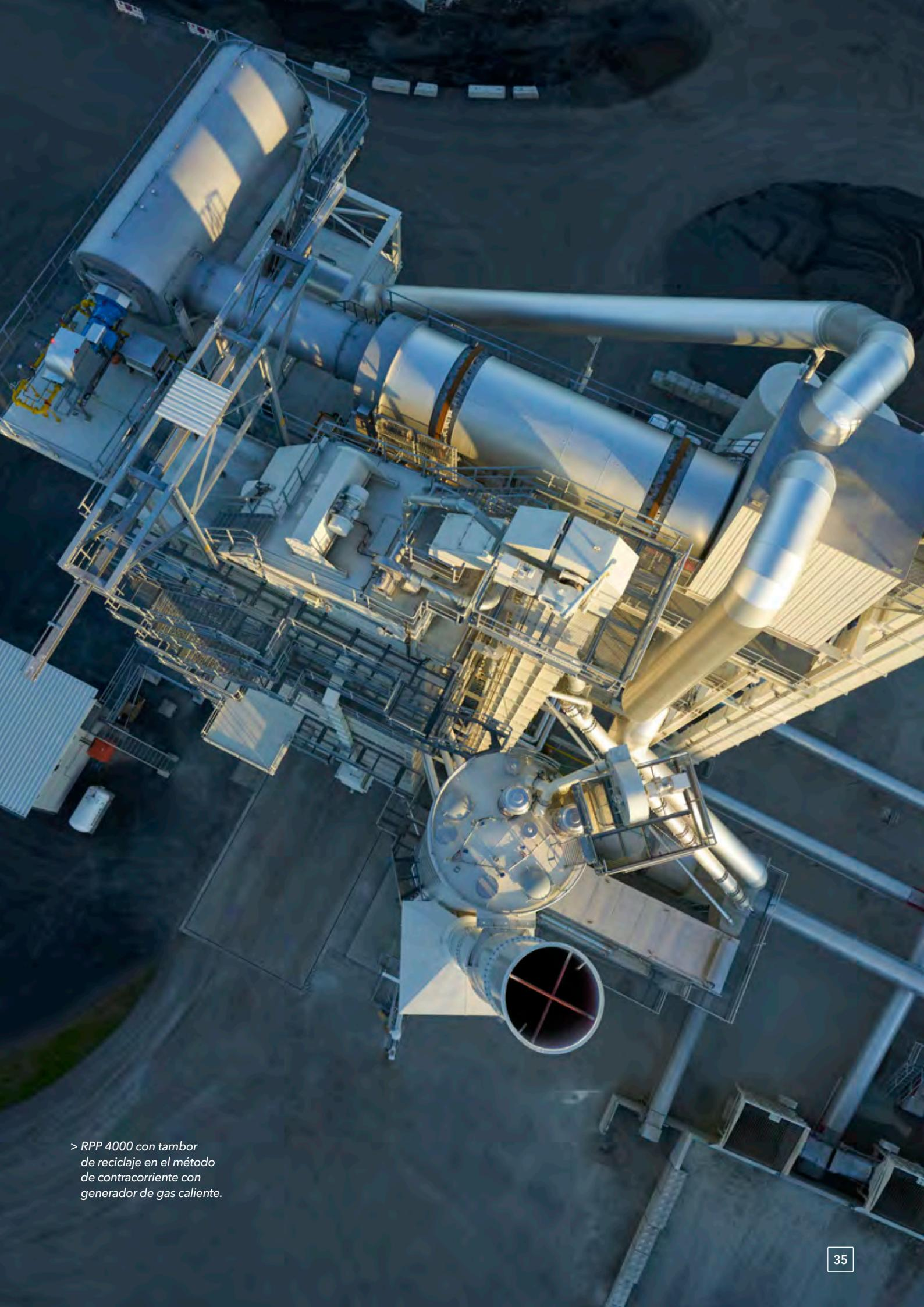
> RPP 4000 con tambor de reciclaje en el método de contracorriente con generador de gas caliente.
