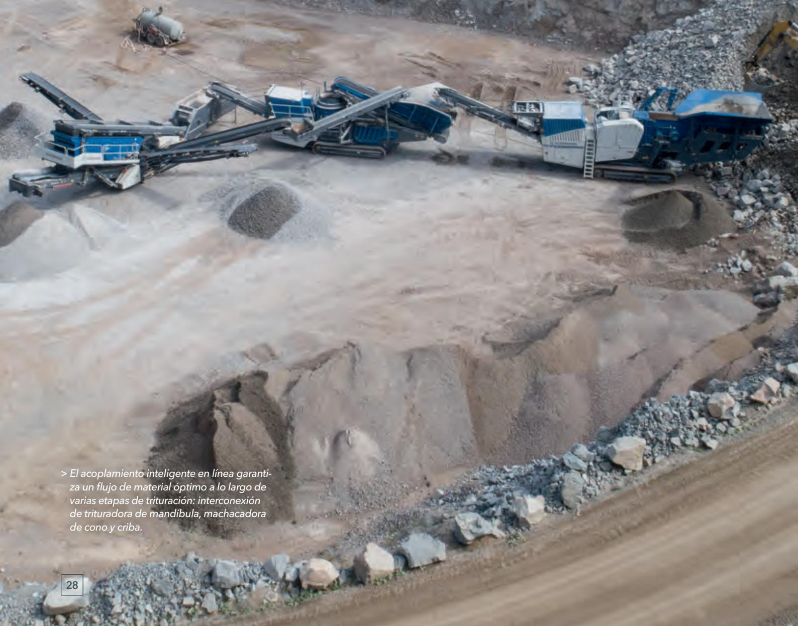
> El acoplamiento inteligente en línea garantiza un flujo de material óptimo a lo largo de varias etapas de trituración: interconexión de trituradora de mandíbula, machacadora de cono y criba.
