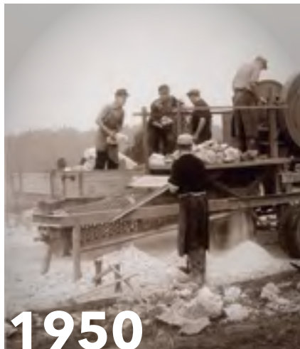
Колесная щековая дробилка KLEEMANN с ручной загрузкой и барабанным грохотом.
