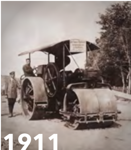
HAMM construye el primer rodillo de asfalto con motor diésel del mundo.
