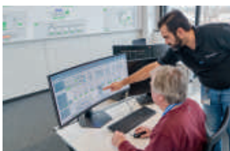
Le système de commande moderne BLS 4 de BENNINGHOVEN est destiné à la gestion des centrales d'enrobage et est axé sur la fonctionnalité et la simplicité d'utilisation.
