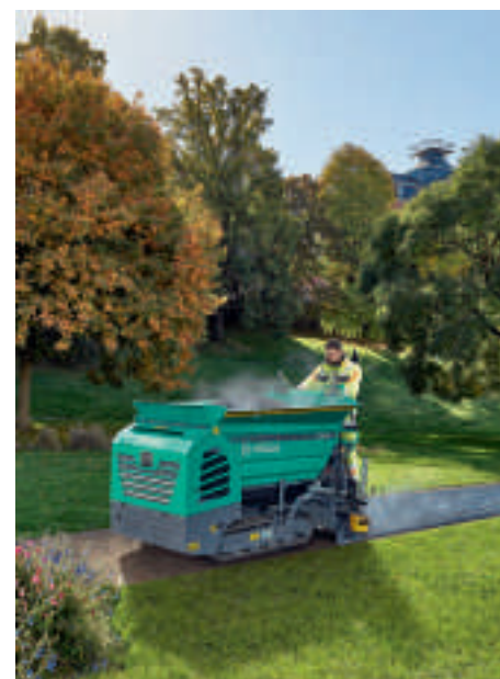
Le plus petit des finisseurs de VÖGELE est en mesure de réaliser des largeurs de pose de 0,25 m seulement.
