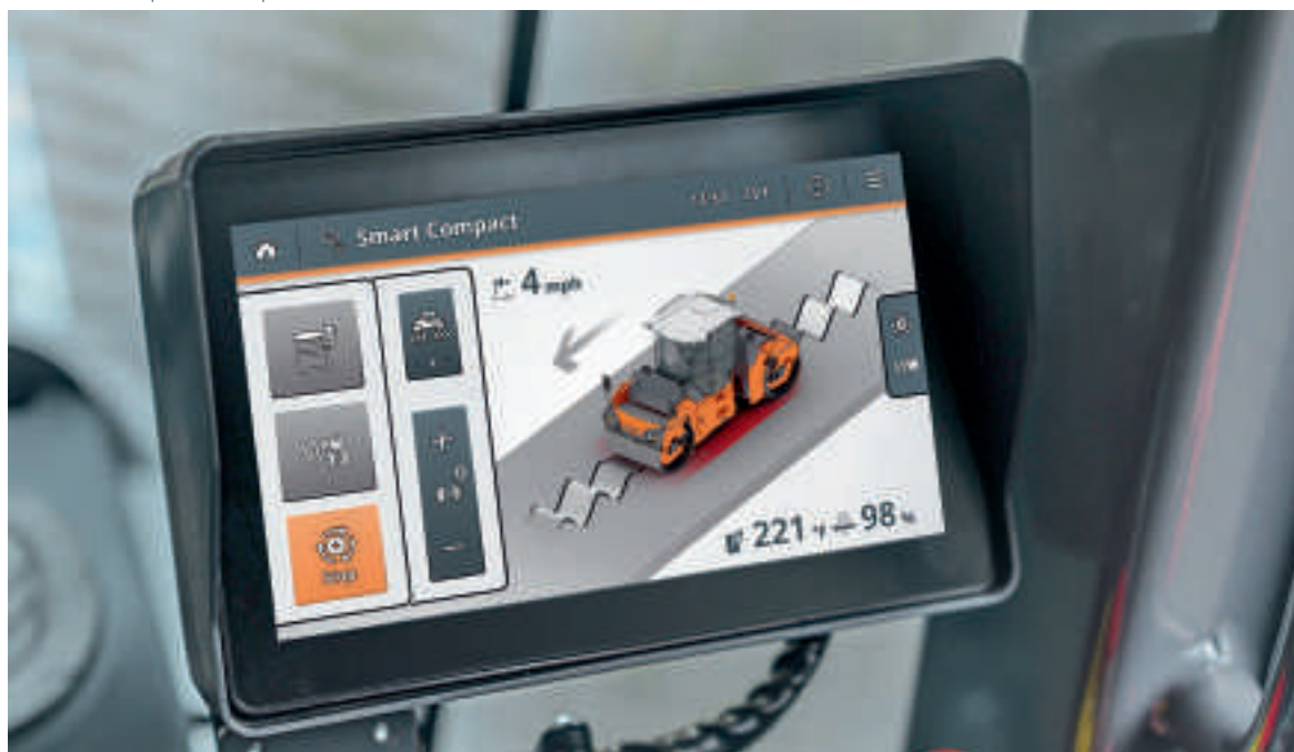
Smart Compact Pro pour le compactage automatisé dans la construction routière sur la base de la compacité en temps réel.
