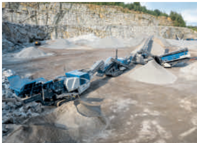
Retraitement optimal des matériaux par des processus de concassage et de criblage à plusieurs niveaux
