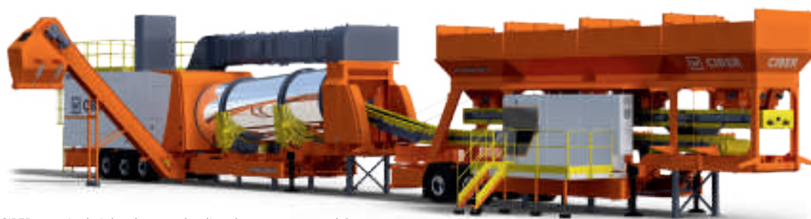
CIBER est spécialisé dans les centrales d'enrobage continues mobiles sur roues. Les installations sont produites à Porto Alegre, au Brésil.
