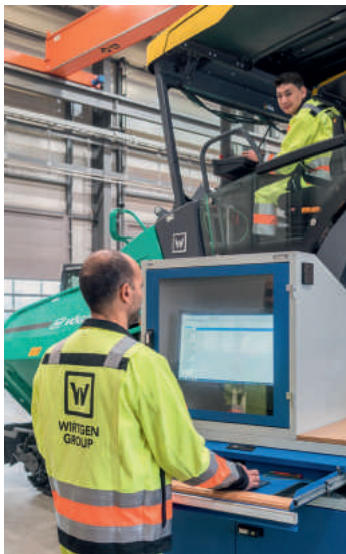
Le système de diagnostic de maintenance WIDIAG assure un diagnostic d'anomalies rapide.
