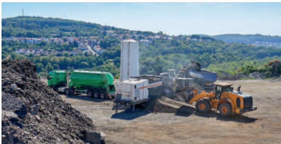
La centrale mobile de recyclage à froid KMA 240 (i) affiche un rendement de malaxage exceptionnel de plus de 240 t/h.
