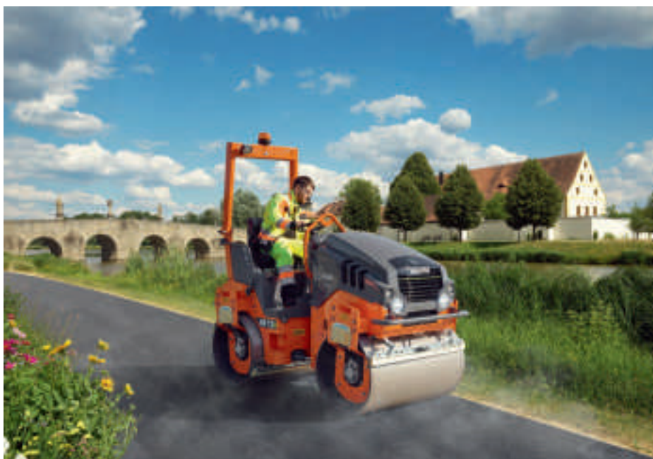
Compacteurs électriques à batterie pour moins d'émissions de CO 2 et sonores.
