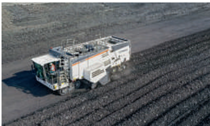
Le Surface Miner 220 SM (i) 3.8 avec un tambour de taille de 3,8 m pour l'extraction efficace de roches tendres.
