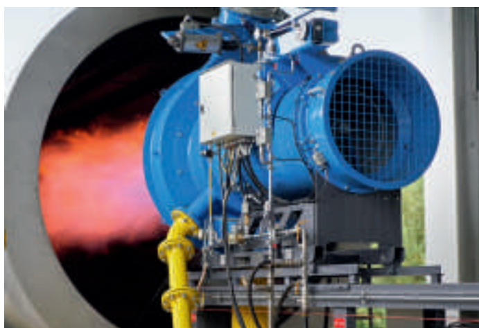
Le brûleur multi-combustible MULTI JET permet d'utiliser simultanément jusqu'à 4 combustibles, solides, liquides ou gazeux.
