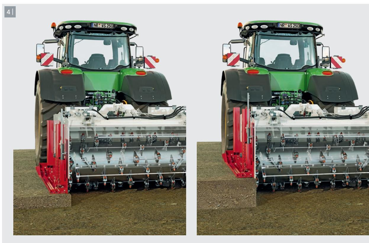
2 | La protección lateral en combinación con el tope mecánico garantiza una profundidad de trabajo constante.
