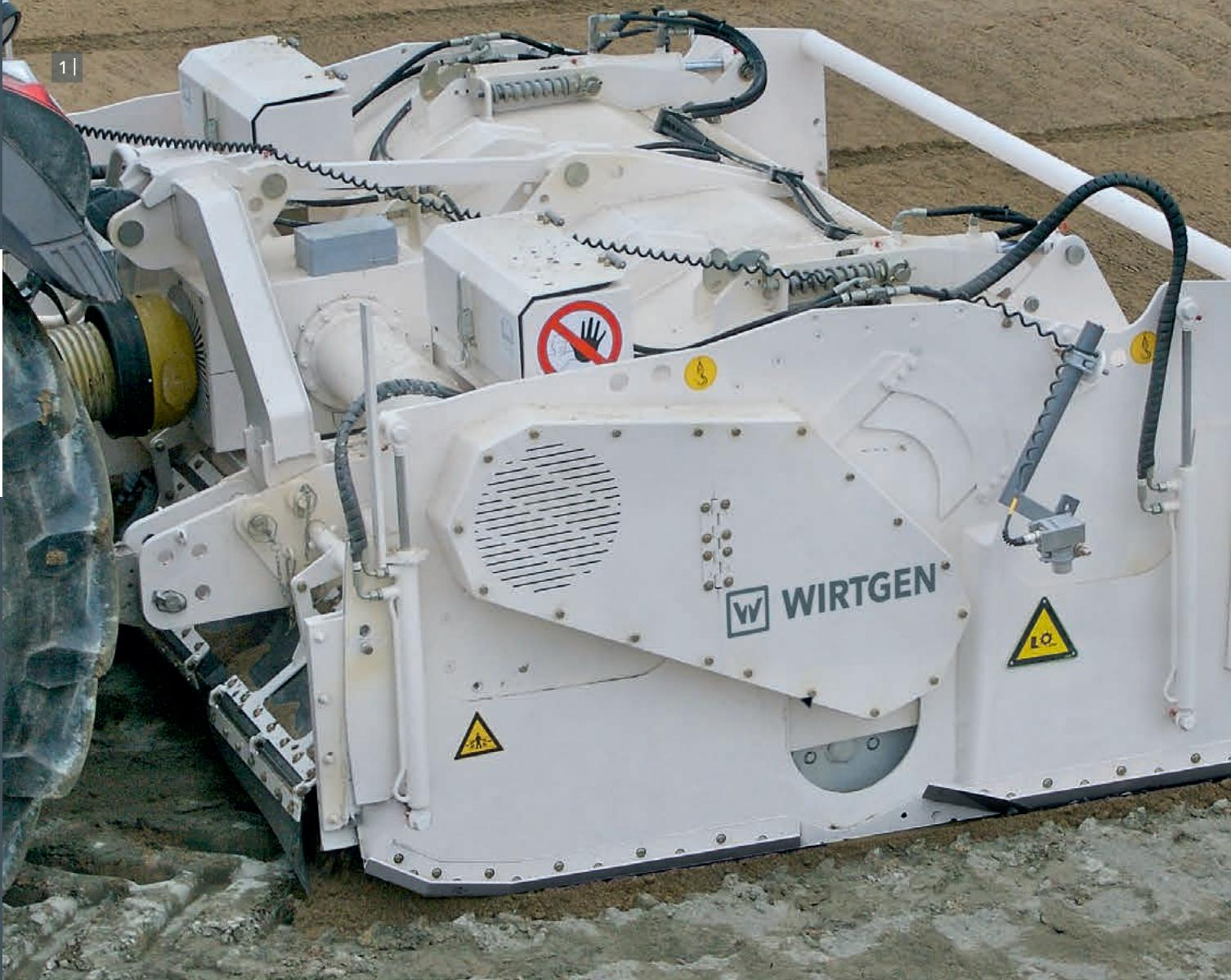
1 | Solo el rotor de fresado y de mezcla se encuentra en el suelo. La profundidad de fresado actual se puede controlar mediante un indicador digital de la profundidad de fresado.
