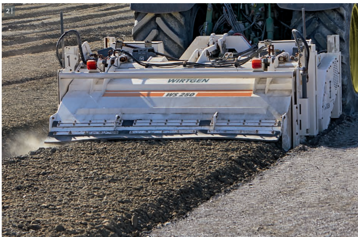
2 | Ottimi risultati di miscelazione e un comportamento esemplare in fase di spianamento del terreno sono i segni distintivi della stabilizzatrice semiportata.
