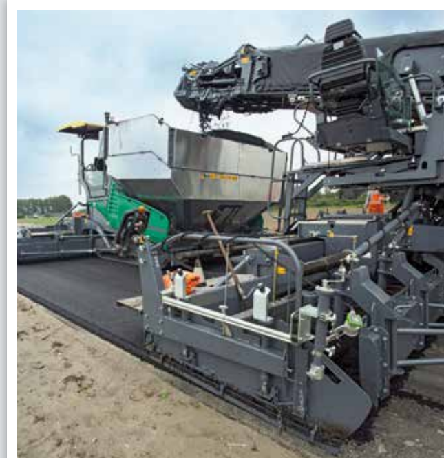
Über das Übergabemodul des Binderschichtfertigers gelangt das Mischgut zum Deckenfertiger.
