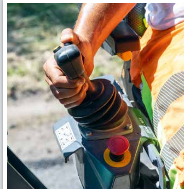
Die Bedienung des Schwenkbandes erfolgt über einen Joystick in der Armlehne.
