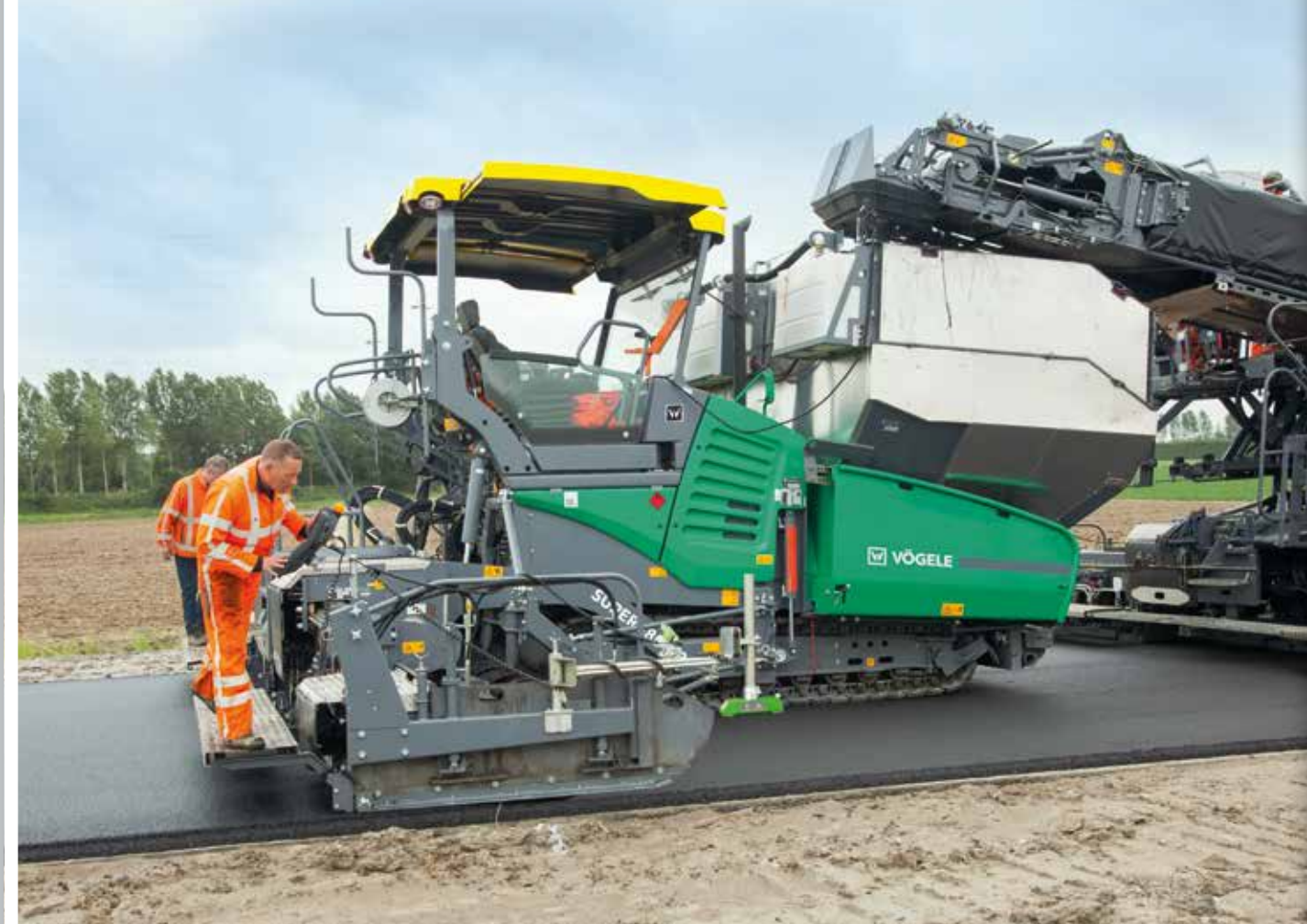
Im 25 Tonnen fassenden Behälter lässt sich eine große Menge Deckenmaterial bevorraten.
