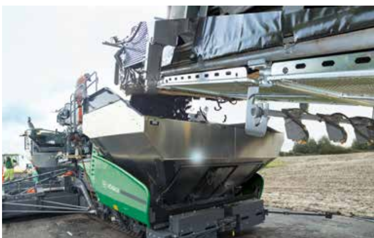
Das Band des Übergabemoduls ist beheizt, um ein Ankleben von Mischgut zu vermeiden.
