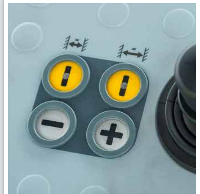
Die automatische Abstandsregelung ermöglicht das Einstellen von zwei unterschiedlichen Abständen.
