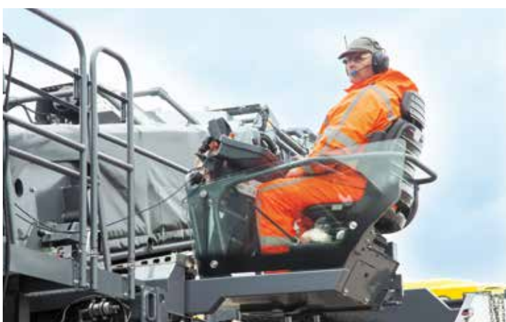
Dank der zwei höhenverstellbaren Bedienstände hat der Fahrer eine optimale Sicht auf den kompletten Baustellenablauf.
