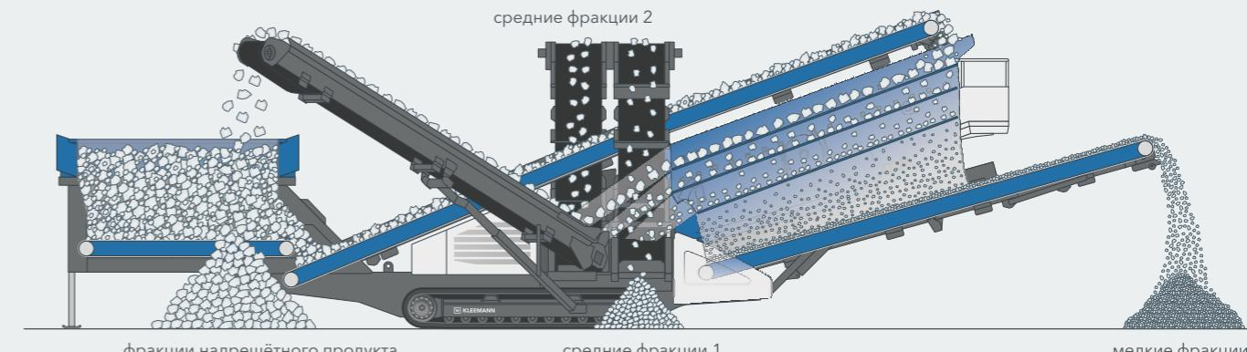
За счёт компактных транспортных габаритов, короткого времени наладки и широкого выбора просеивающих панелей сортирующие грохоты MSC EVO универсальны в эксплуатации. Для эффективной обработки больших объёмов доработана конструкция системы транспортировки материала: начиная с загрузочного бункера, расширяющегося в направлении потока материала, который далее подаётся к широкому загрузочному конвейеру и затем попадает на большую
