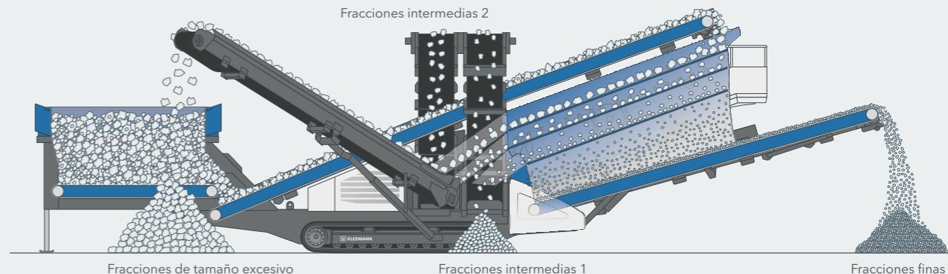
Gracias a sus dimensiones compactas para el transporte, los cortos tiempos de montaje y la amplia selección de superficies de criba, las instalaciones de cribado de clasificación MSC EVO se pueden utilizar de forma flexible. Para un procesamiento eficiente de grandes volúmenes, se ha optimizado el diseño del flujo de material: desde la tolva de alimentación, que se ensancha en la dirección del flujo del material, hasta la amplia cinta de alimentación y la
