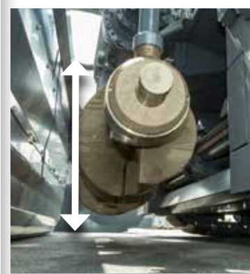
Sollevamento/abbassamento della coclea distributrice e del telaio.
