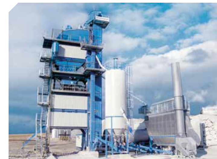
// ECO 3000 AVEC TREMIES DE STOCKAGE D'ENROBÉS EN SOUS-ÉTAGE
