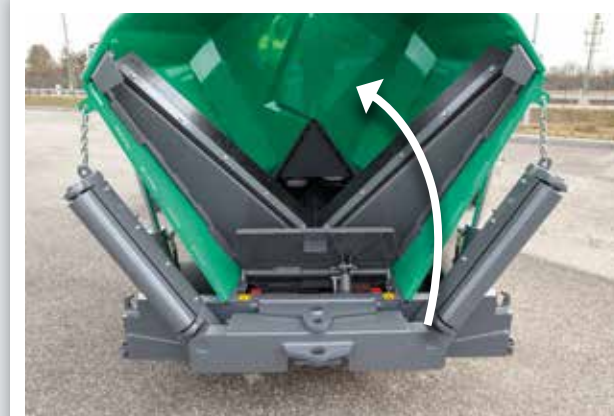
RELEVER LE CLAPET DE RECENTRAGE DE LA TRÉMIE
