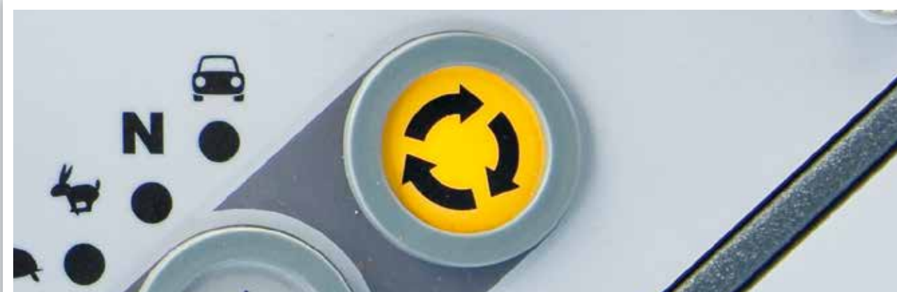
UNE SIMPLE PRESSION SUR LA TOUCHE D'EXÉCUTION PERMET DE LANCER LA FONCTION DE REPOSITIONNEMENT « AUTOSET BASIC ».
