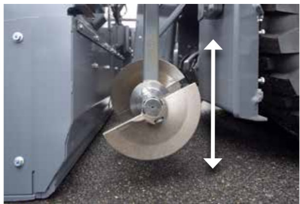
RELEVER/ABAISSE LA VIS DE RÉPARTITION
