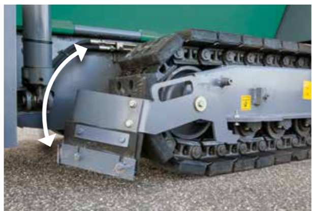
RELEVER/ABAISSE LES DÉFLECTEURS DES TRAINS À CHENILLES
