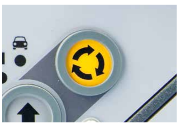
UNE PRESSON SUR LA TOUCHE D'EXÉCUTION PERMET DE LANCER LA FONCTION DE REPOSITIONNEMENT « AUTOSET BASIC ».
