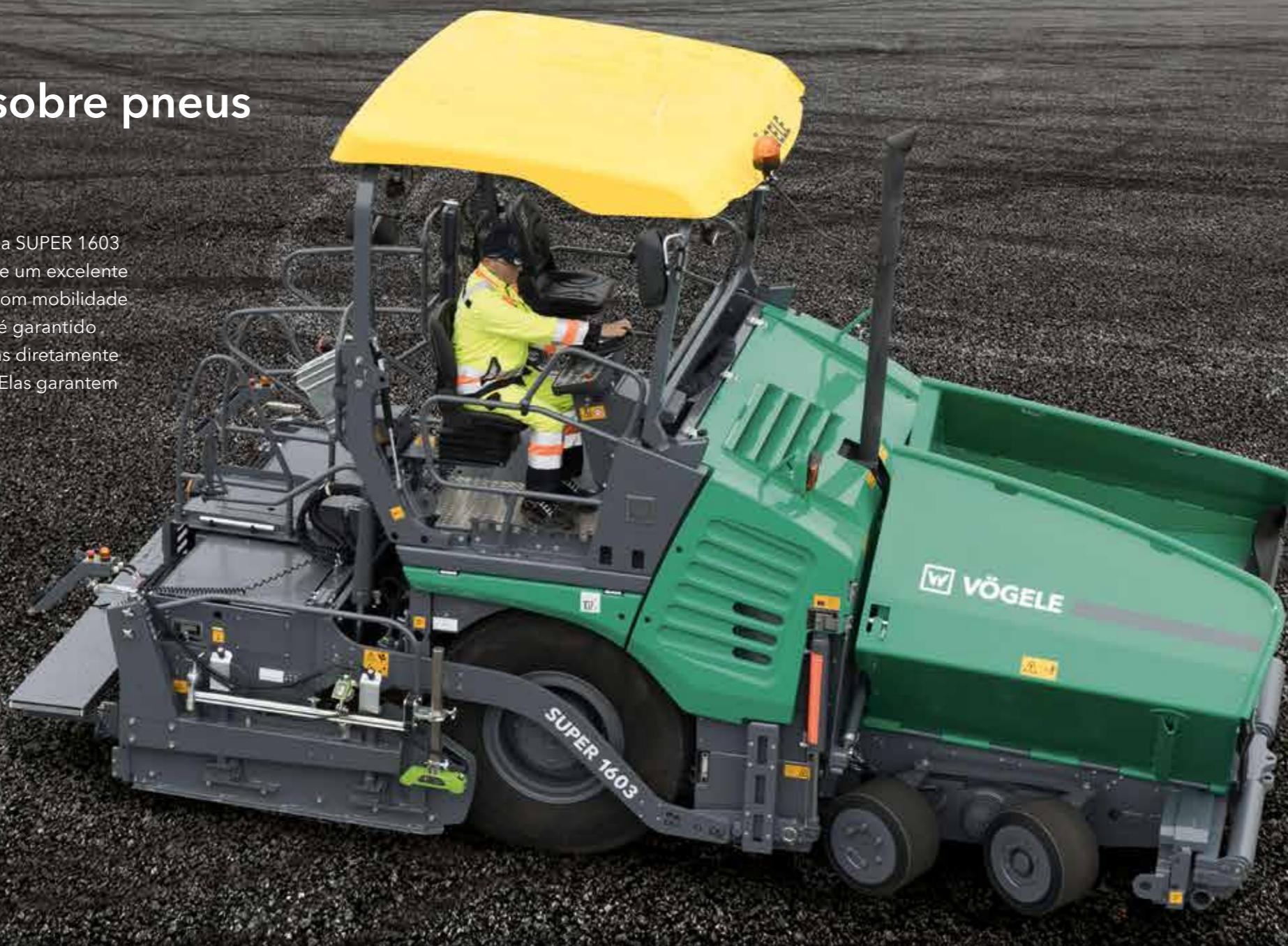
» **Transferência rápida em sua própria potência** a até 20km/h – um feito para o qual a SUPER 1603 é idealmente equipada. Todas as funções de pavimentação são automaticamente desativadas quando o modo "Deslocamento em estrada" é selecionado.
