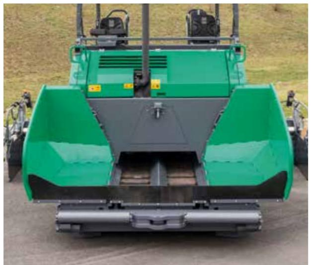
» **La gran tolva receptora** tiene una capacidad de 13 toneladas, por lo que siempre se dispone de suficiente mezcla para el extendido, incluso en las condiciones de alimentación más complejas, por ejemplo, bajo los puentes.
