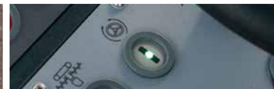
**Manejabilidad extrema** gracias a "Pivot Steer": Con el freno de dirección "Pivot Steer" activado, la rueda interior trasera se frena automáticamente por medios hidráulicos. Con ello se reduce el radio de giro exterior en el posicionamiento y el extendido a solo 3,5 m.
