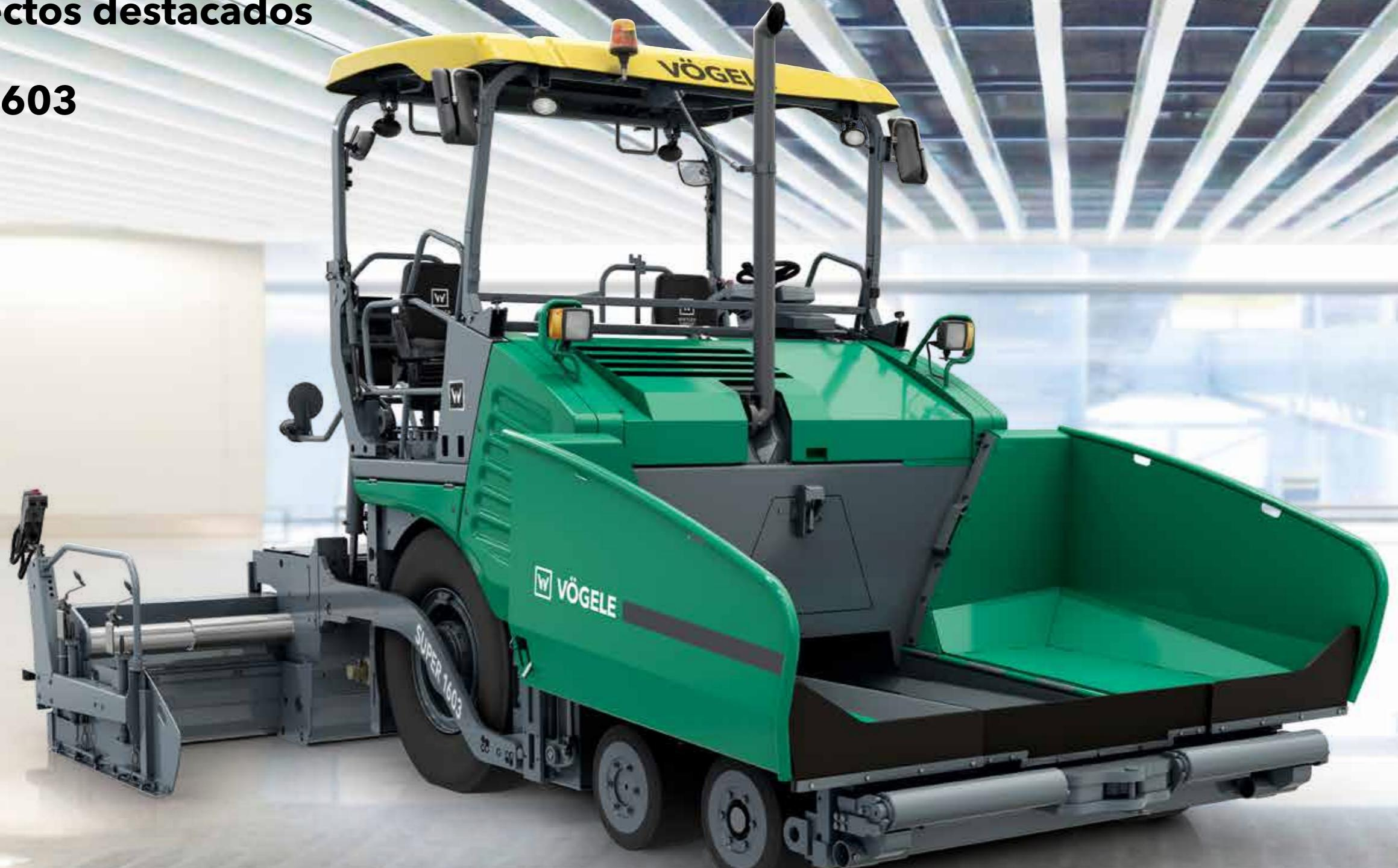
**Potente y eficiente** gracias al motor con 116 kW
